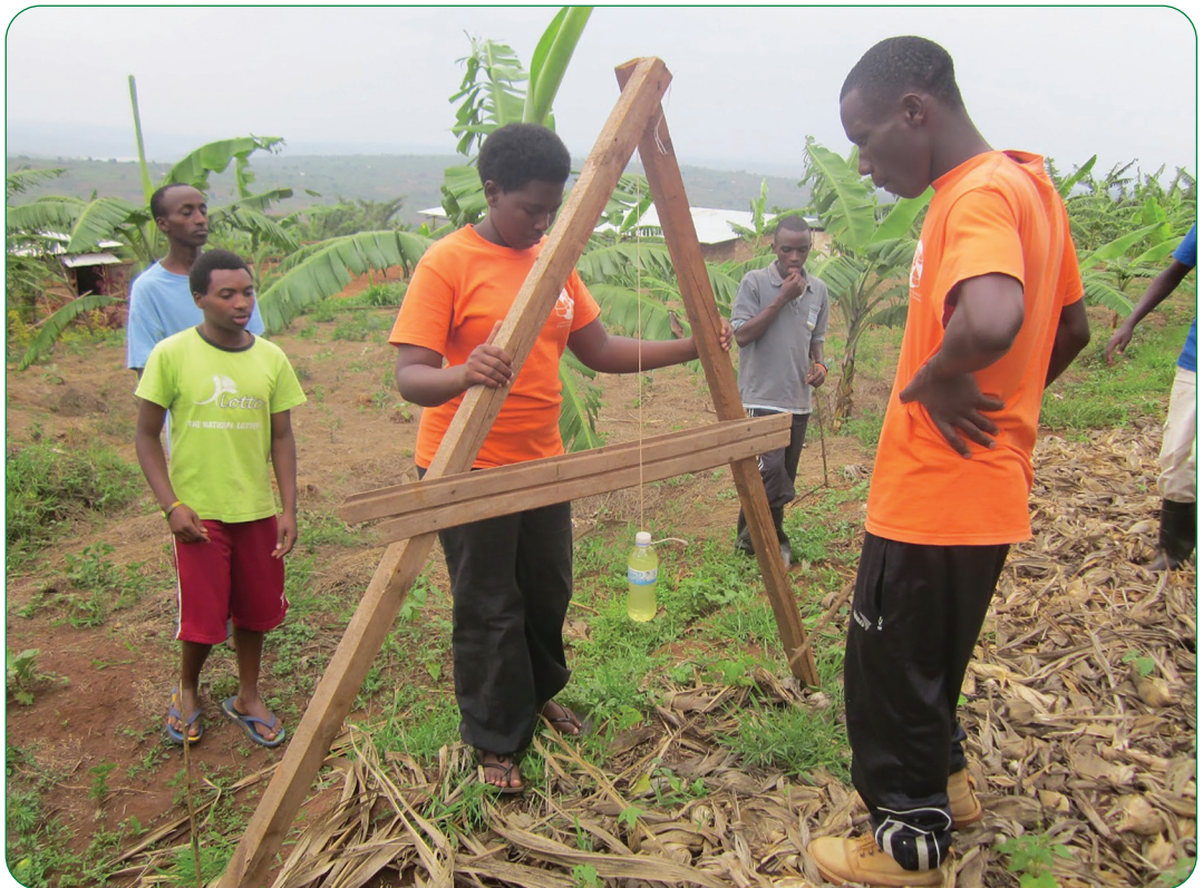
Fig. 1.38: Using an A-frame
